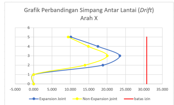
Gambar 19 Perbandingan Simpang Antar Lantai Akibat Beban Gempa Dinamik Arah X
