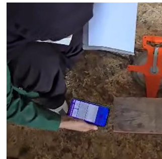
Gambar 5 Mendeteksi mutu dengan alat Wood Quality Detector
