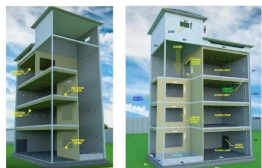
Gambar 3. Detail Desain Sarang Burung Walet (Sumber : www.dianwalet.com )
